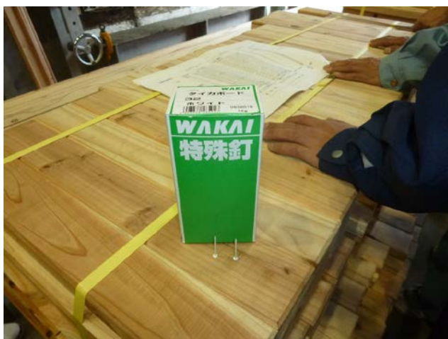
くぎ(接合材固定用) \phi 1.7 \times L 32
