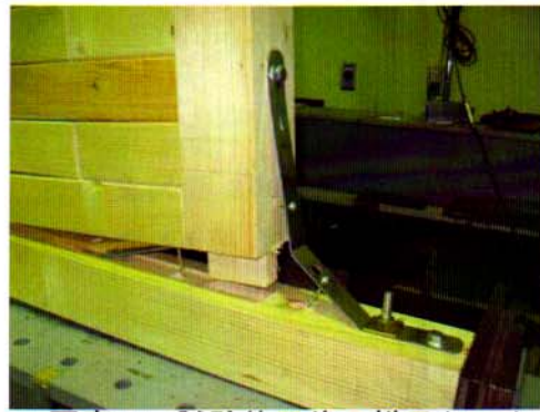
写真 11 試験終了後の様子(No.3) 右柱脚部の様子
