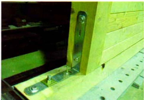
写真 12 試験終了後の様子(No.3) 左柱脚部の様子
