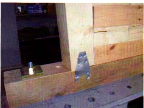
写真 16 試験終了後の様子(No.4) 左柱脚部の様子
