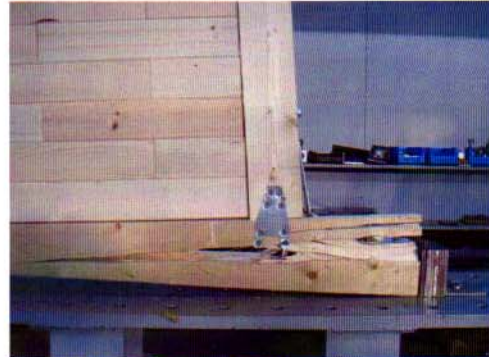
写真7 試験終了後の様子(No.2) 右柱脚部の様子
